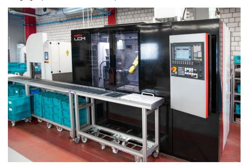
Die Superfinish-Maschine »LCM TS« zur Bearbeitung von Fahrwerkskomponenten arbeitet seit 2016 zuverlässig im Dreischichtbetrieb. Bild: Supfina
