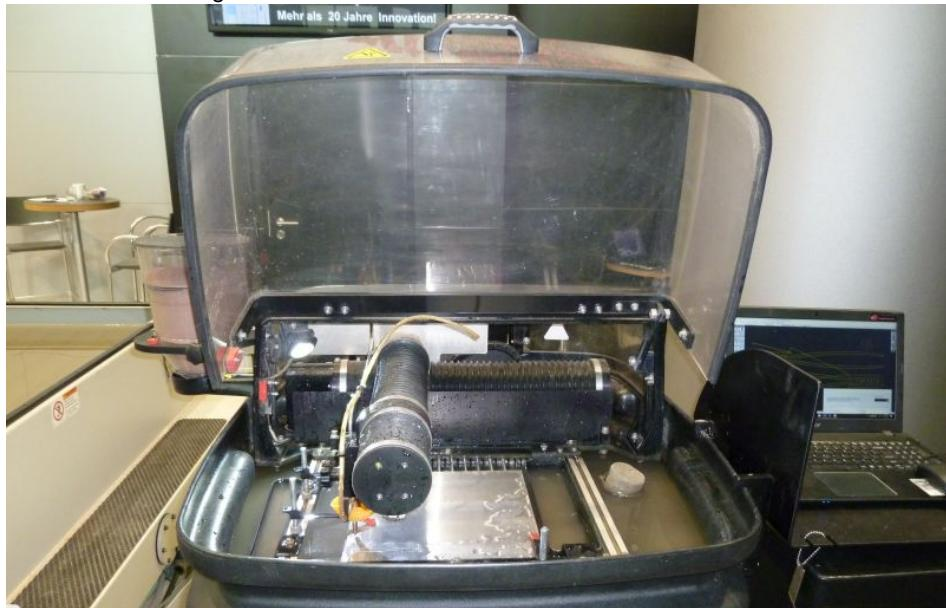
Das Wasserstrahlschneidsystem ist besonders zur Herstellung von Prototypen geeignet.
