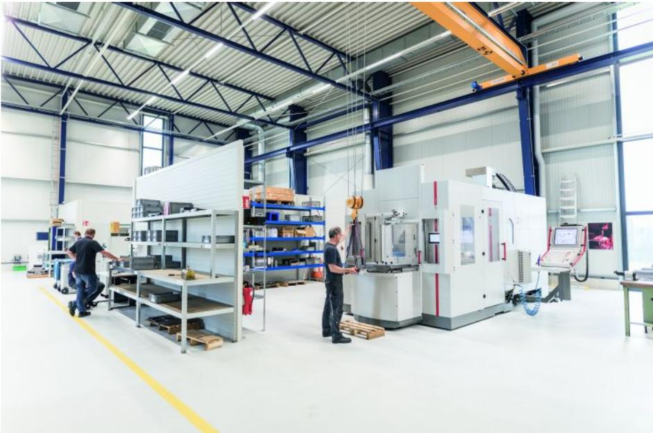
Das Hermle-Fertigungszentrum bei der  $\mu$ -Tec GmbH in Chemnitz, bestehend aus einem 5-Achsen-Bearbeitungszentrum »C 42 UP« und einem Palettenwechsler mit frontseitigem Rüstplatz. Bild: Hermle
