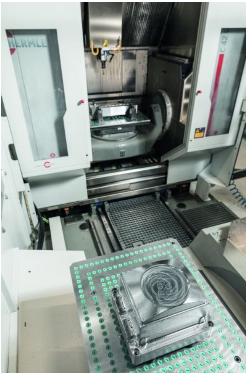
Wechselbereich des Dreifach-Palettenwechslers mit drei Paletten im Speicher. Bild: Hermle
