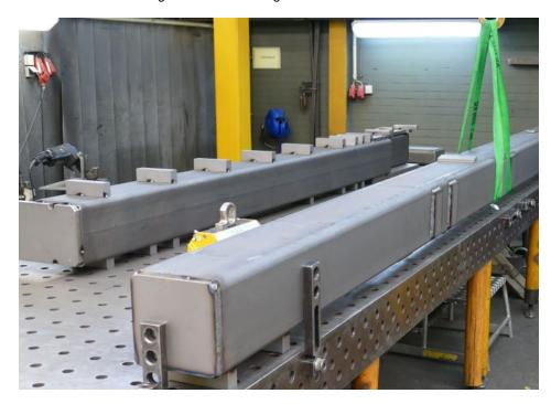
Die Basiselemente des zu schweißenden Werkstücks werden mit einem Kran und über mechanische Anschläge auf der Werkbank in die korrekte Lage gebracht. Bild: Z-Laser
