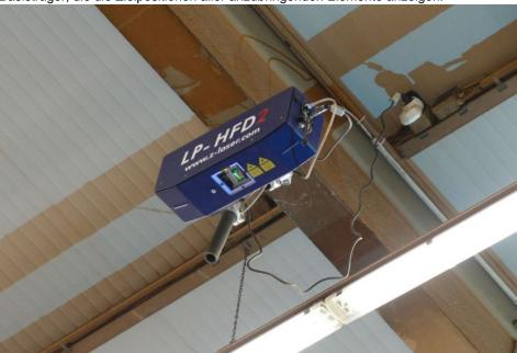
Das Laserprojektionssystem »LP-HFD2« von Z-Laser ist in einer Höhe von rund sechs Metern an der Hallendecke über dem Schweißarbeitsplatz installiert. Bild: Z-Laser
