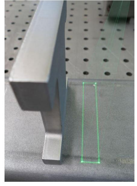
Die Bauelemente können mit der geforderten Genauigkeit von maximal zwei Millimetern angeheftet werden. Bild: Z-Laser
