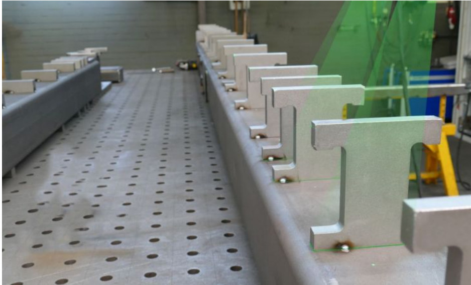
Die Positionen der erforderlichen Bauelemente werden mithilfe gut sichtbarer, grüner Laserprojektionen angezeigt. Bild: Z-Laser
