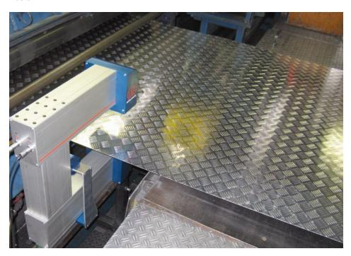
Micro-Epsilon bietet sehr präzise Messanlagen für die Blechdickenmessung. Ihre Stärken zeigen Laser-Profil-Sensoren insbesondere bei der Erfassung von strukturierten Oberflächen. Bilder: Micro-Epsilon
