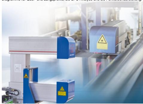
C-Rahmen eignen sich vor allem bei Anwendungen an schmalen Bändern, da bei wachsender Materialbreite die Schwingungsanfälligkeit des oberen Gurtes zunimmt. Bild: Micro-Epsilon
