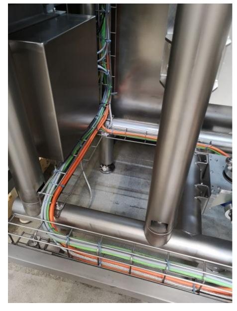
In der »Rotec 3000« läuft die Kabelführung über Edelstahl-Gitterkanäle sehr einfach und übersichtlich. Bild: Lutz/Pflitsch
