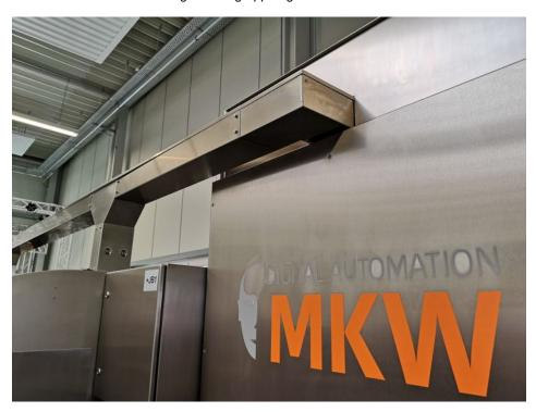
Über den Pflitsch-Industriekanal aus Edelstahl gelingt die sichere Installation der einzelnen Maschinenmodule. Bild: Lutz/Pflitsch
