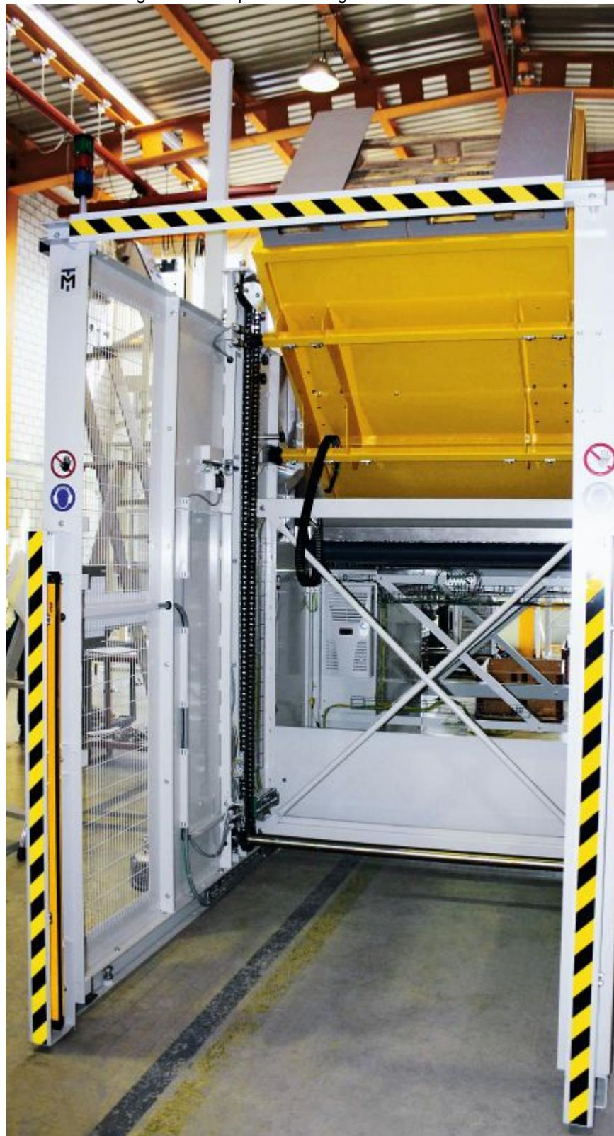
Die Lichtgitter in der Anwendung. Bild: Pilz
