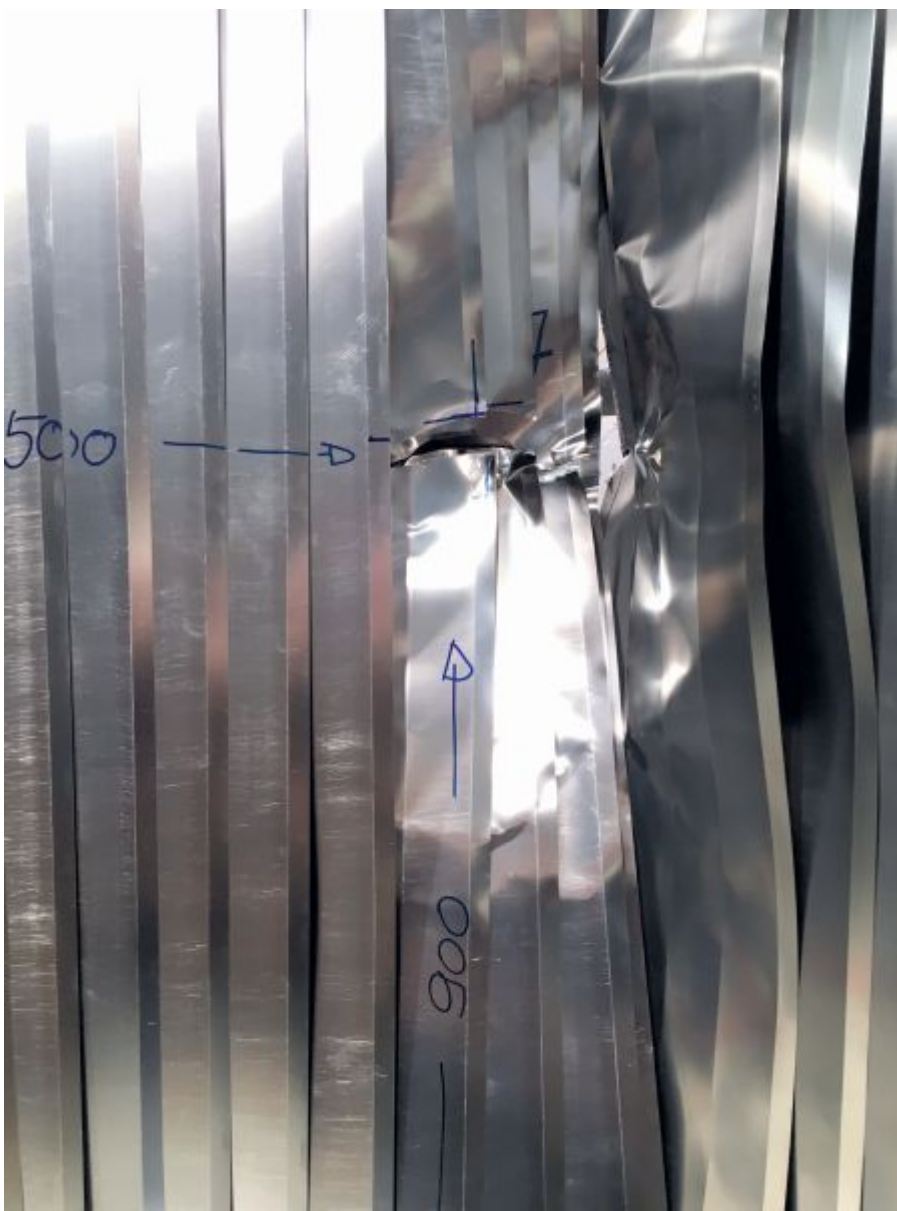
Drei der vier neu konstruierten Abdeckungen für die Rückwände des 5-Achs--Fräsbearbeitungszentrums mit Drehoption bestanden den Beschusstest nach Klasse C1/DIN EN ISO 2312. Bild: Hema
