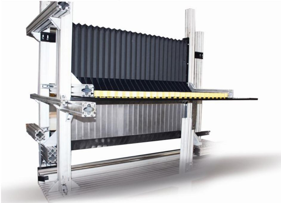
Getestet werden unter anderem das Knickverhalten der Materialien und der Verschleiß der Gleit- beziehungsweise Rollenführungen. Bild: Hema
