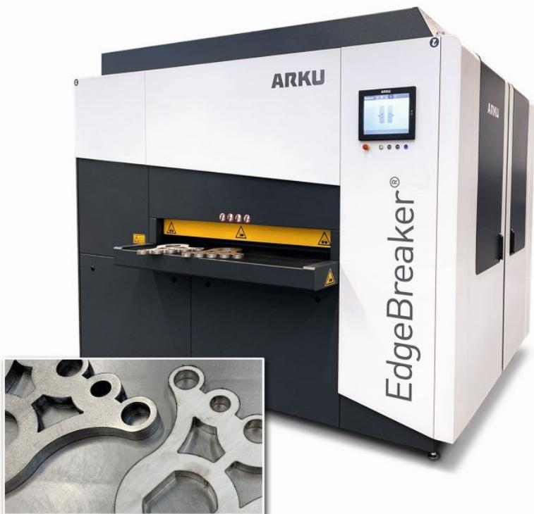
Beidseitige Entgratung und Kantenverrundung für Laserteile in einem Durchgang bietet die neue Entgratmaschine. Bild: Arku
