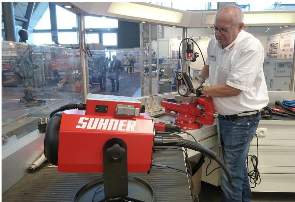
Jürgen Weich, technischer Fachberater bei Suhner, zeigt, wie mit dem drehzahlgeregelten Antrieb (von 500 bis 13000 min-1 in 100er Schritten) für jedes Schleifmittel immer die richtige Drehzahl zur Verfügung steht. Bild: Kuhn
