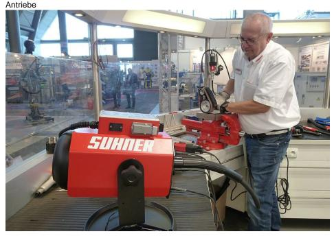
Jürgen Weich, technischer Fachberater bei Suhner, zeigt, wie mit dem drehzahlgeregelten Antrieb (von 500 bis 13000 min-1 in 100er Schritten) für jedes Schleifmittel immer die richtige Drehzahl zur Verfügung steht. Bild: Kuhn
