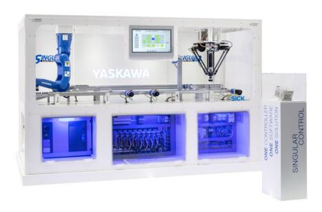
Die Live-Demozelle zwigt, wie sich Roboter, Servoantriebe, Frequenzumrichter und I/O's über einen einzigen Controller steuern lassen. Bild: Yaskawa
