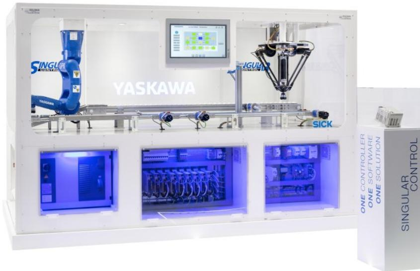
Die Live-Demozelle zwinge, wie sich Roboter, Servoantriebe, Frequenzumrichter und I/O's über einen einzigen Controller steuern lassen. Bild: Yaskawa
