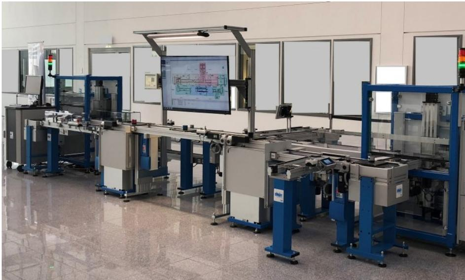
Vernetzte Werkstückträger-Transportsysteme machen die Montage effizienter. Bild: Stein
