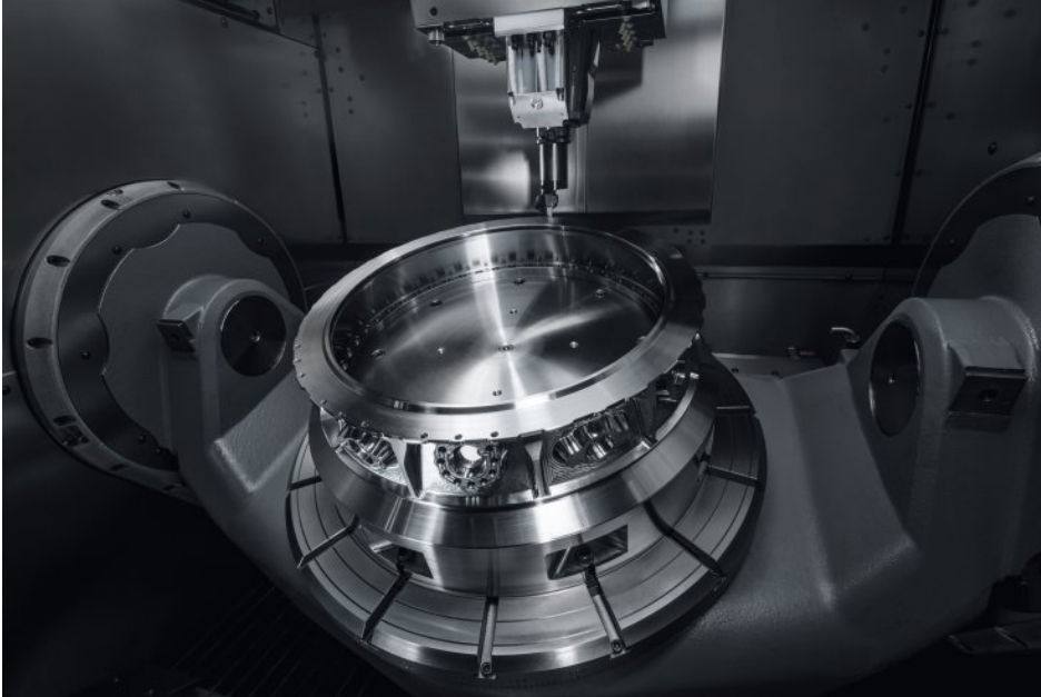
Bearbeitung eines Triebwerksgehäuses. Bild: Hermle
