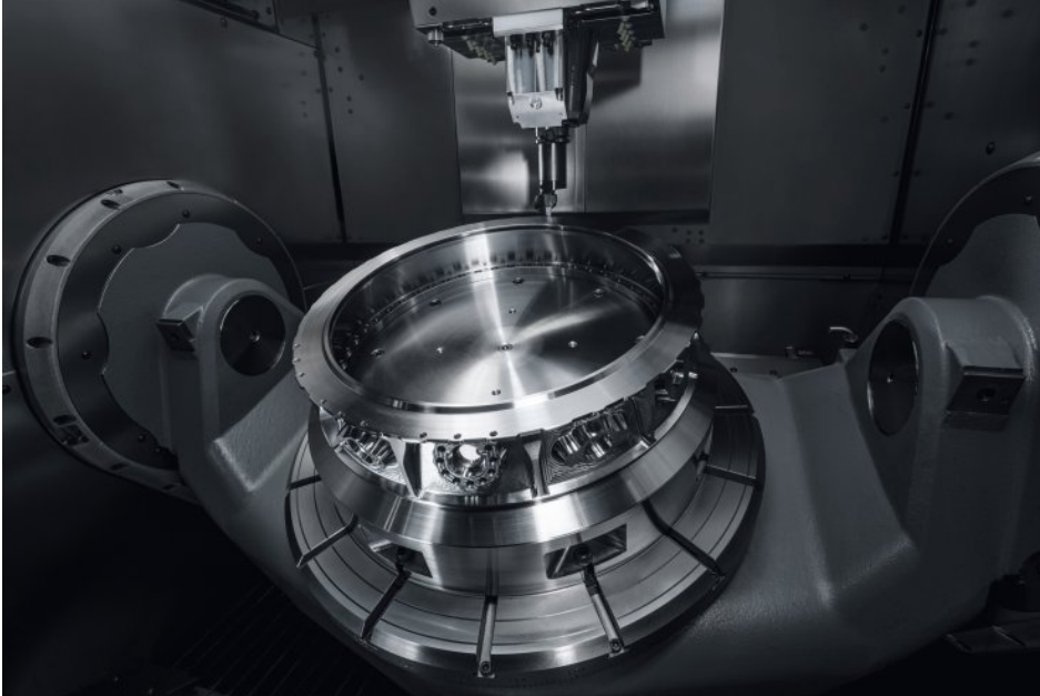
Bearbeitung eines Triebwerksgehäuses. Bild: Hermle
