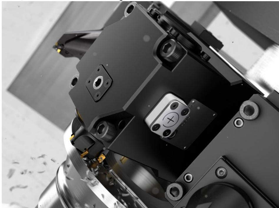
Angetriebene Werkzeughalter reduzieren Maschinenstillstandszeiten mittels vorausschauender Instandhaltung. Bild: Sandvik Coromant
