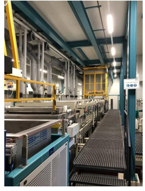
BENSELER bietet nun auch das Chemische Badentgraten (CBE) an. Bei diesem Prozess durchlaufen die Bauteile in Körben 14 bis 16 Stationen.
