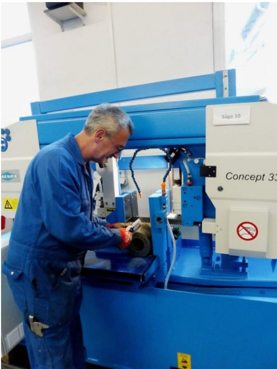
Neu im Maschinenpark von ALBROMET ist eine horizontale Bandsäge, mit der sehr gute Schnittoberflächen bei geringsten Toleranzen erzielt werden.
