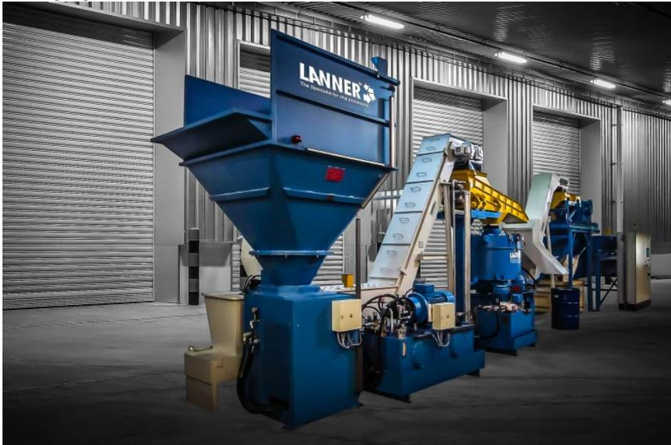
Vollautomatische Späneaufbereitungsanlagen für bis zu 10 m<sup>3</sup>/h von LANNER kommen unter anderem in der Aluminium-Räderproduktion zum Einsatz.
