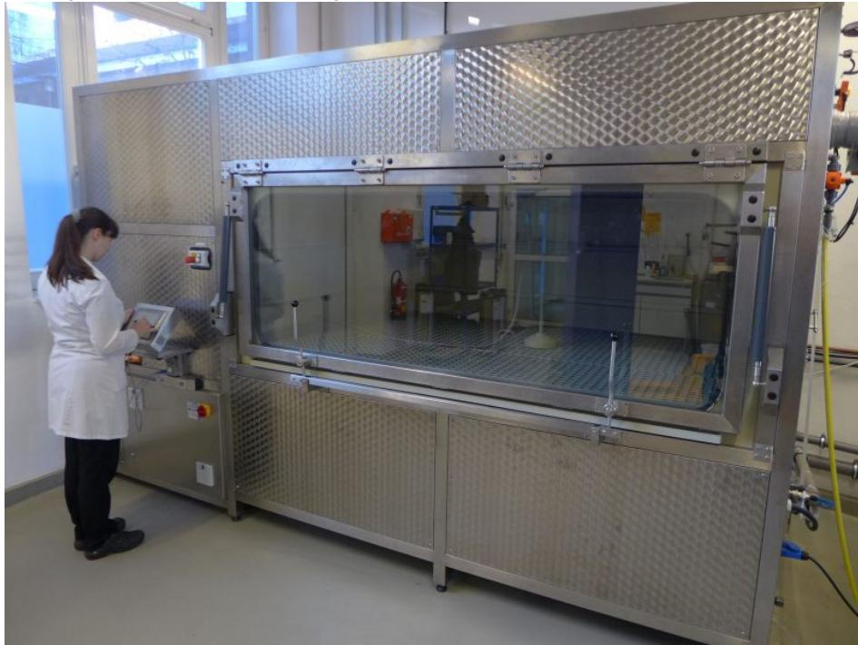
Mit der neuen Korrosionsprüfkammer von IGOS lassen sich Bauteile bis 2,5 m Länge und einem Gewicht von bis zu maximal 500 kg testen.
