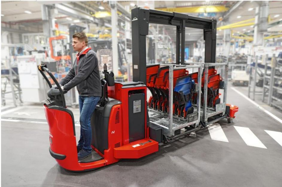
Der Trolley »Supply Truck« ist ein Fahrzeugkonzept von LINDE MH, das die Vorteile des Logistikzugs mit denen eines Gabelstaplers verbindet.
