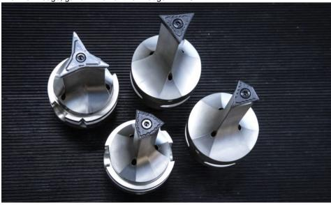
Das »FreeTurn«-Startprogramm besteht aus vier Wendeschneidplatten-Geometrien. Bild: Ceratizit
