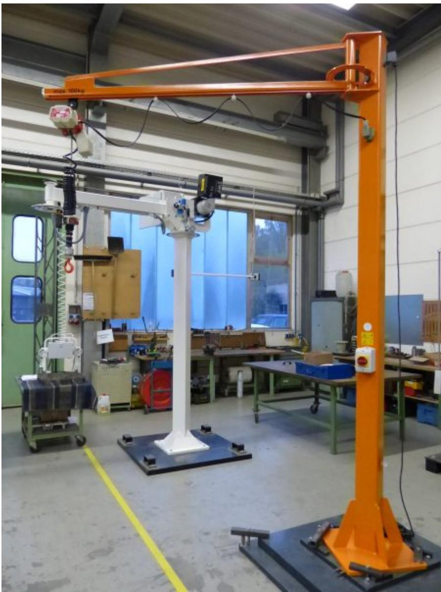
Die Manipulatoren von KITO bestehen aus einer Befestigungsplatte, einer Säule, einem schwenkbaren Ausleger und einer Hubeinheit zum Antrieb.
