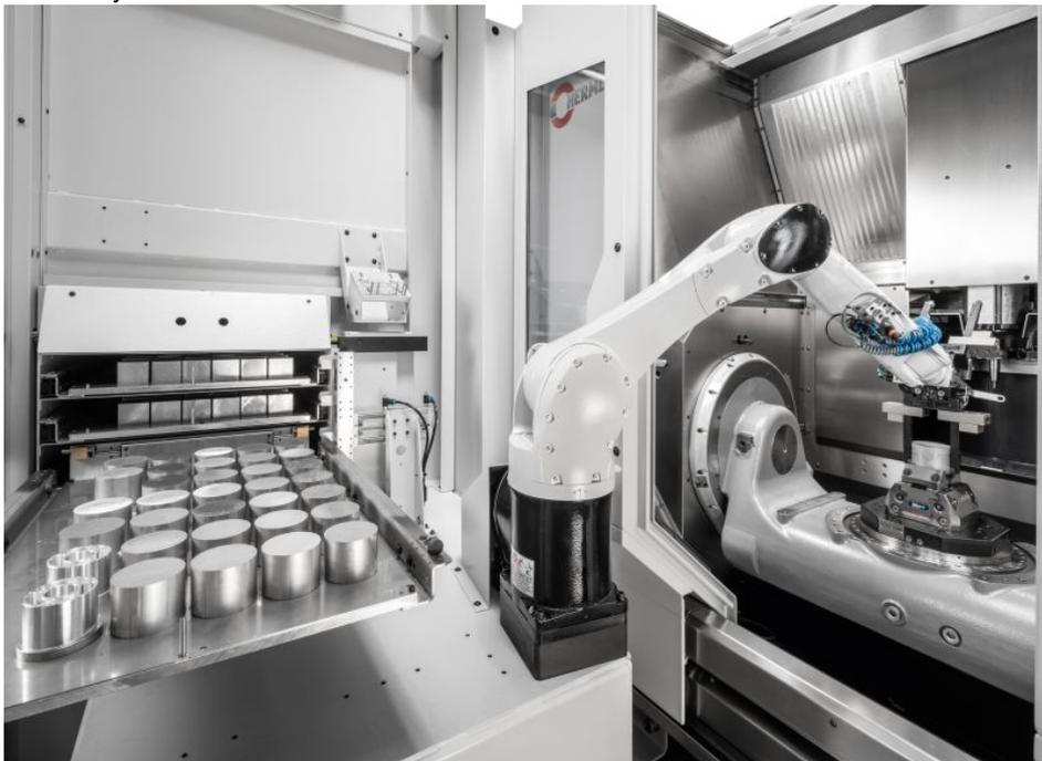
Robotersystem von HERMLE im Automatikbetrieb – mit zahlreichen Rohlingen auf den Matrizenablagen in den Teleskopschubladen im Speichermodul.
