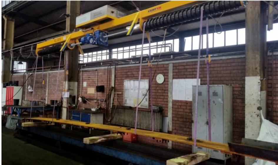
Für ein Projekt wurde von CERTEX eine Wendetraverse zum horizontalen Wenden von scharfkantigen Bauteilen unterschiedlicher Länge entwickelt.
