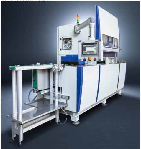
Die Maschine zum Bürstentgraten »DA300P« der SURFINSYS AG entgratet Teile schnell und prozesssicher und sorgt für hohe Oberflächenqualität.
