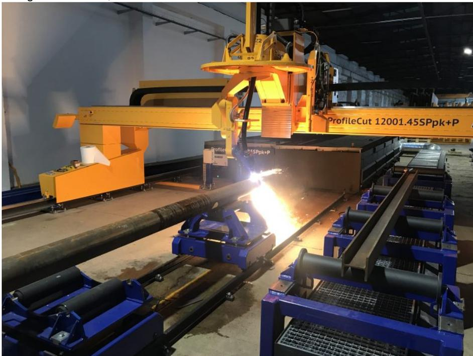
Die Schneidmaschine von MICROSTEP ist mit einer Rohrschneidvorrichtung zum automatischen Positionieren und Schneiden von Rohren ausgerüstet.
