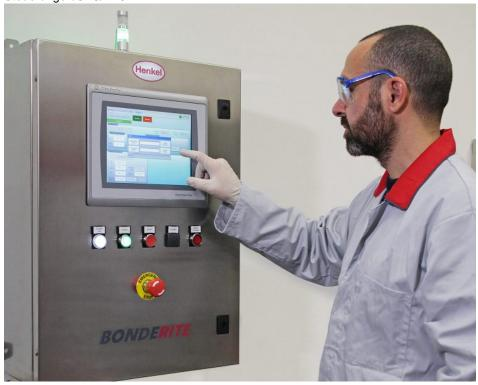
Das Prozesssteuerungssystem »Bonderite E-CO DMC« von HENKEL verfügt über einen Touchscreen und ist mit einem internen Speicher ausgestattet.
