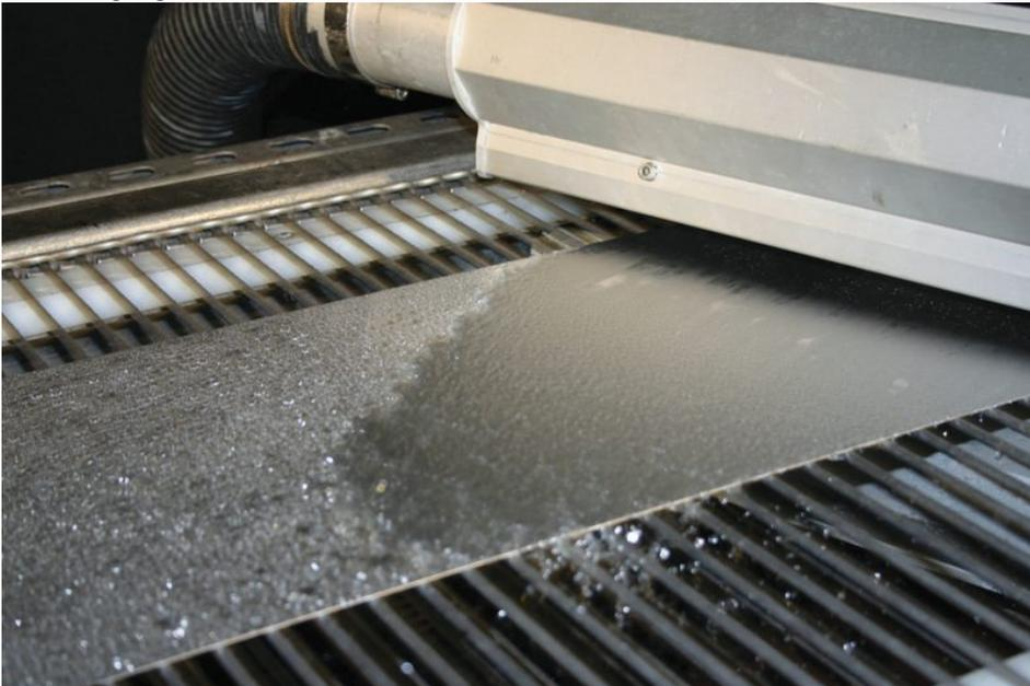
Luftklingen von CARL VON GEHLEN reinigen, trocknen oder kühlen u. a. Bauteile, Motorkomponenten oder kleine Teile wie Kabel und Drähte.
