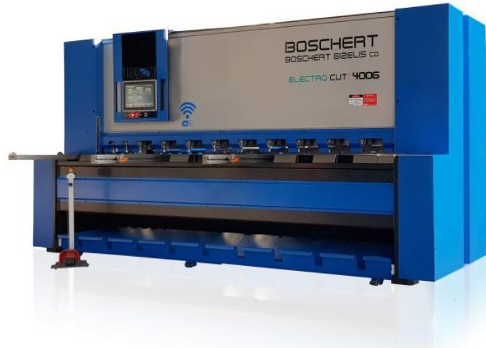
Die »G-Electro Cut« von BOSCHERT mit ihrem Antriebskonzept aus AC-Servomotor mit Riementrieben ist derzeit einmalig auf dem Markt.
