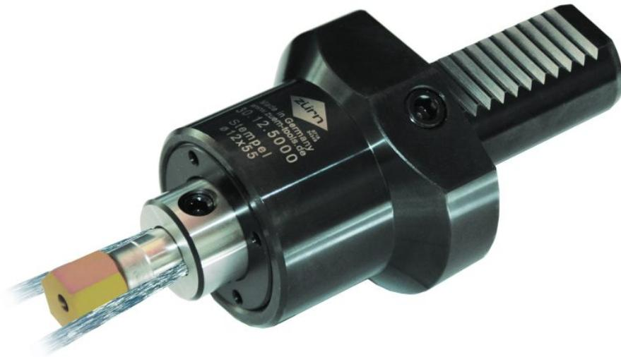
Ein Räumwerkzeughalter DIN ISO 10889 von ZÜRN mit Räumstempel zur Herstellung von Sechskant-Innenprofil SW 12 auf Drehmaschinen.
