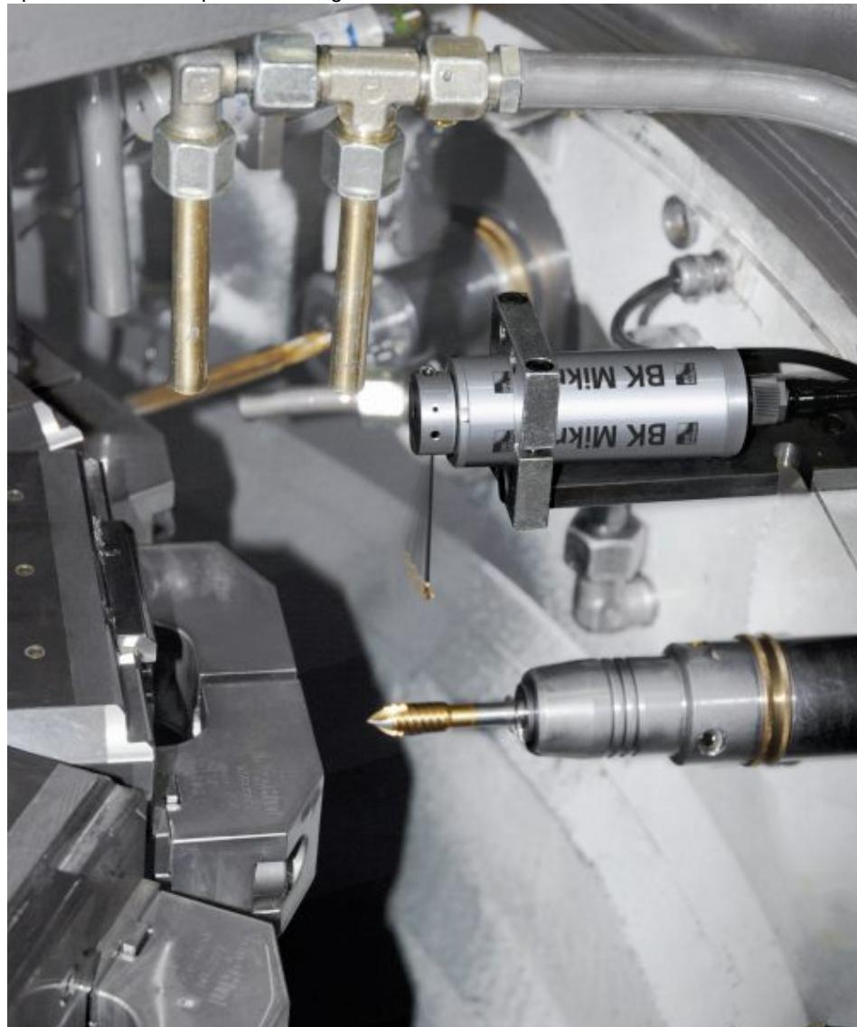
Die Überwachungssysteme von »BK Mikro«, einer Produktmarke von SCHUBERT, gewährleisten die sichere Kontrolle von Produktionsprozessen.
