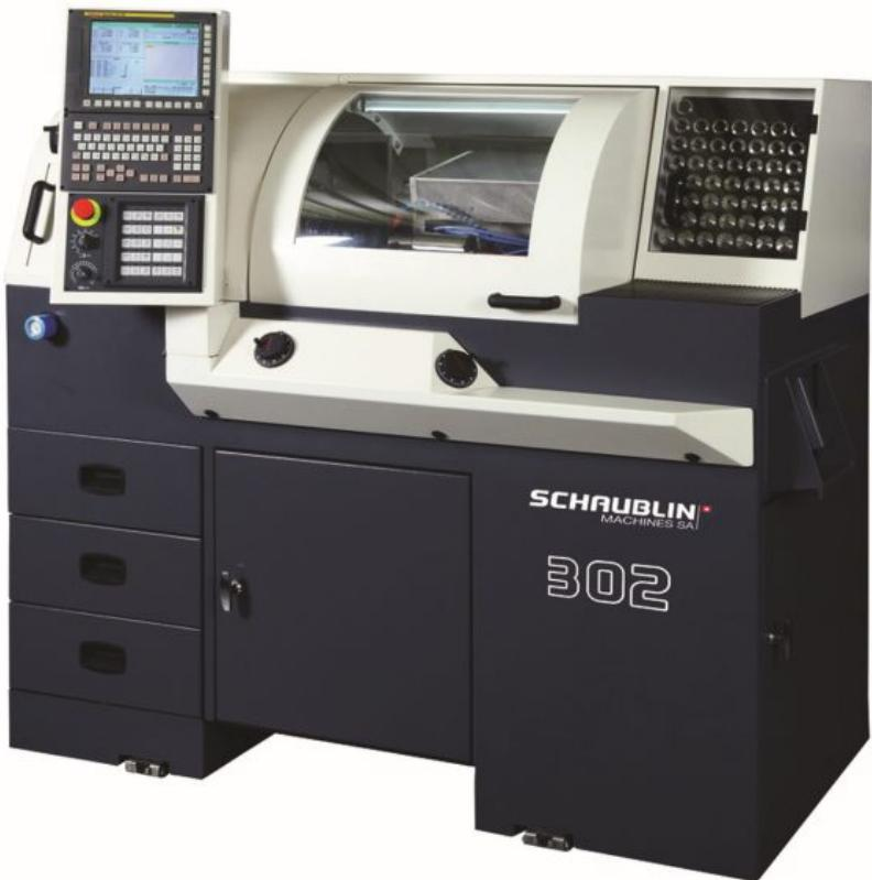
Die Universal-Drehmaschine »302« von SCHAUBLIN kann für die verschiedenen Arbeitsbereiche kundenspezifisch konfiguriert werden.
