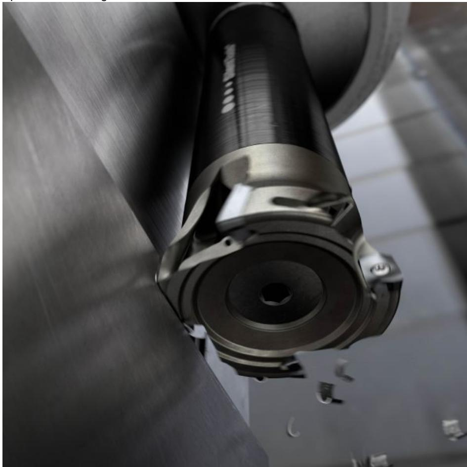
Das Werkzeug »CoroMill 390« von SANDVIK COROMANT in Leichtbauweise mit additiv gefertigtem Fräserkörper bietet Anwendern viele Prozessvorteile.
