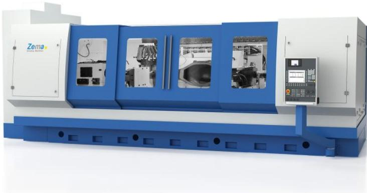
Die »Numerika GH 3500 2W« von JUNKER bearbeitet Werkstücke synchron mit zwei Schleifspindelstöcken. Dadurch sinken die Gesamttaktzeiten.
