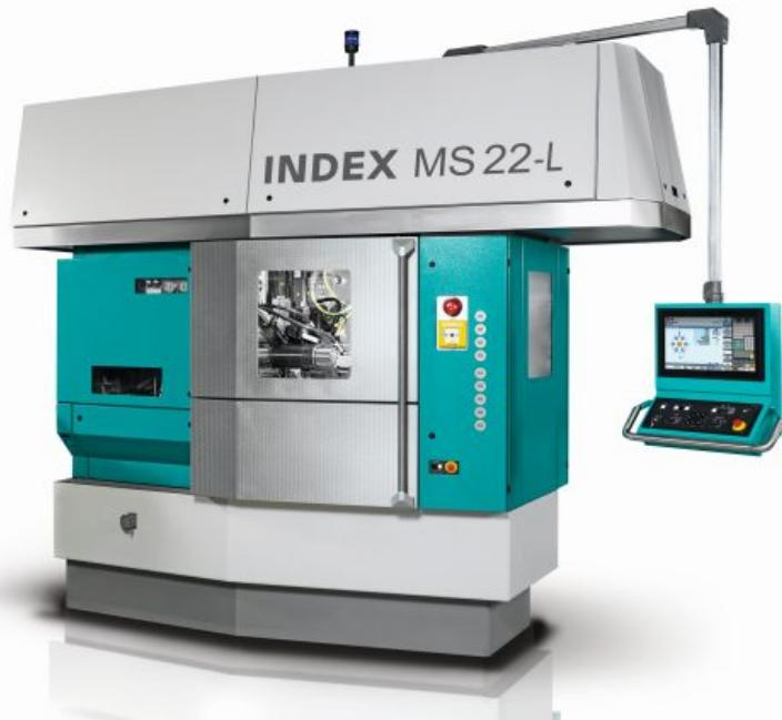
Das Maschinenkonzept der »MS22-6L« der INDEX-WERKE als frontoffene Maschine zur Stangenbearbeitung steht für sehr gute Zugänglichkeit.
