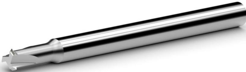
»WHC/WHD« – Rotierendes VHM-Werkzeug aus dem System »Tourin« von HOBE zur Herstellung von Gewinden als Vollprofil mit einer Zahnreihe.
