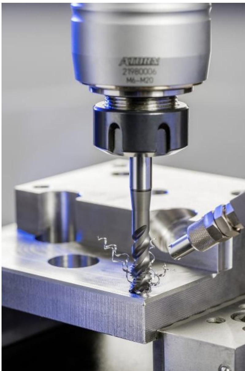
Für das präzise Einbringen von Gewinden in der Serienfertigung bietet HAHN+KOLB die Universal-Hochleistungsgewindebohrer von Atorn.
