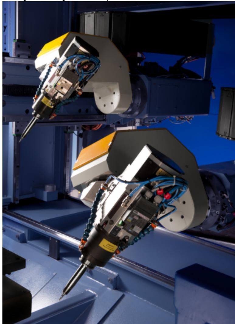
Das 5-Achs-Bearbeitungszentrum »DC 7« mit einem oder zwei unabhängigen 5-Achs-
