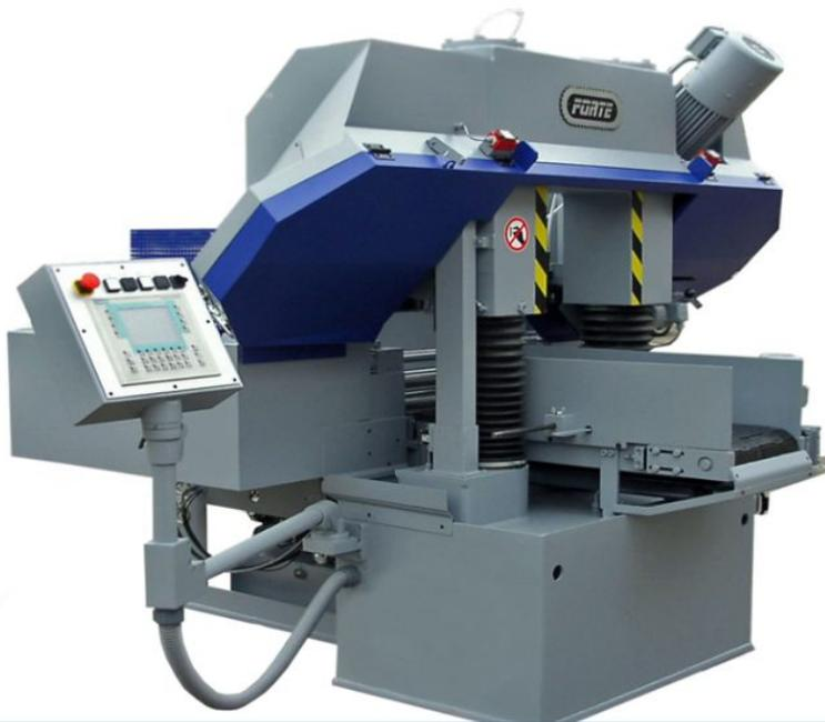
Der 2-Säulen-Bandsägeautomat von FORTE hat eine Schnittgeschwindigkeit von 11-110 m/min und deckt einen Schneidbereich von 10 bis 360 mm ab.
