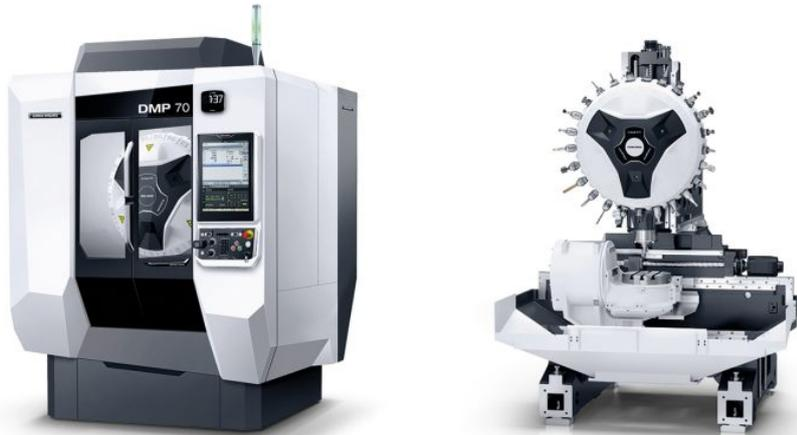
Bei einer Aufstellfläche von lediglich 4,2 m<sup>2</sup> bietet die Produktionsmaschine »DMP 70« von DMG MORI Verfahrwege von 700 x 420 x 380 mm.
