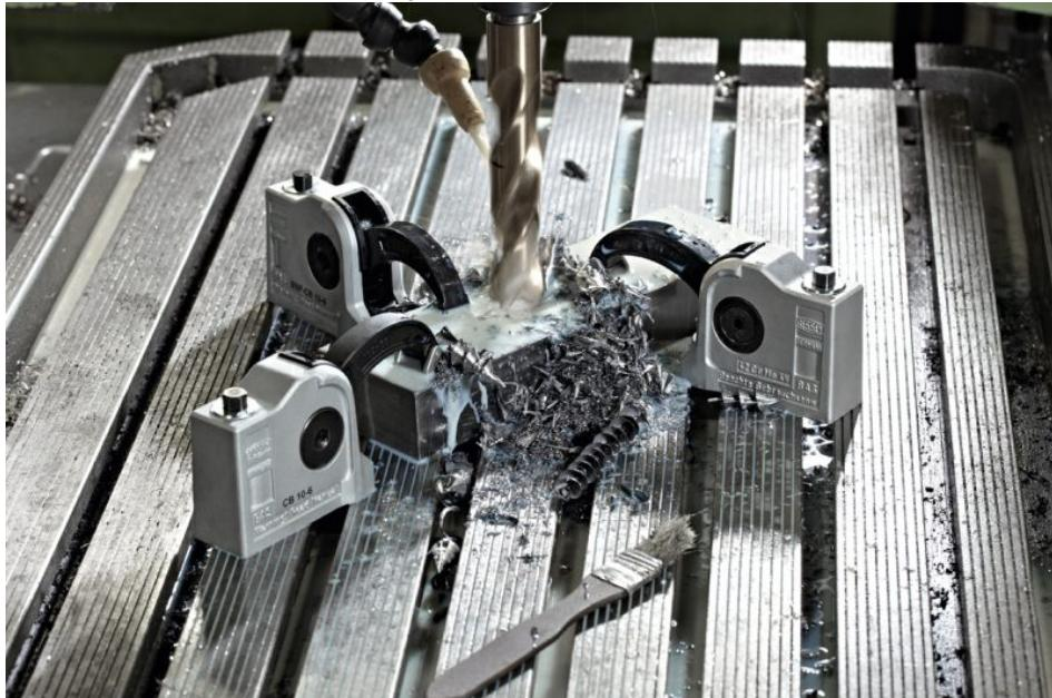
Die Maschinentischspanner-Modelle »BAS-C« und »BAS-CB« mit drei Druckarm-Varianten von BESSEY erreichen Spannkräfte bis zu 16.000 N.
