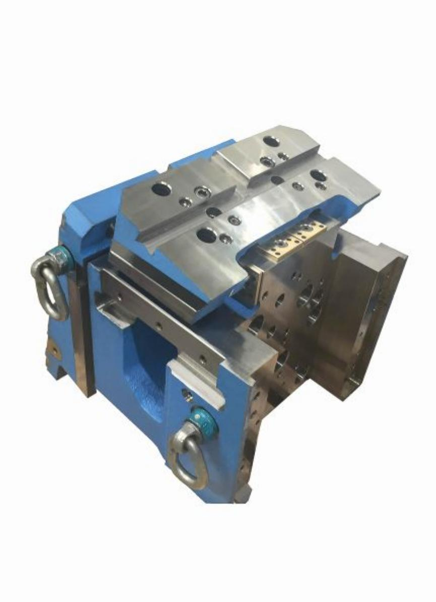
Ein neues Schieberkonzept mit dem Treiber im Werkzeugoberteil entwickelte Strack Norma mit dem »PMON«.
