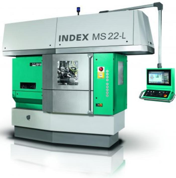
Die Index-Werke stellen mit der »MS22-L« einen CNC-Mehrspindeldrehautomaten in einer Langdrehversion vor. Damit ist es gelungen, auf die »MS22« eine Langdreheinheit aufzusetzen, mit der alle typischen Vorteile der Mehrspindler des Herstellers erhalten bleiben. Somit kann das Werkstück in einer Spindellage gleichzeitig vor- und fertiggedreht werden. Bei vielen Kombinationen aus Bauteilgröße, Komplexität und
