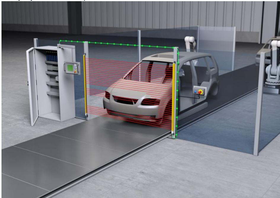
Die prozessgesteuerte Zugangssicherung realisiert Leuze electronic mit »Smart Process Gating«.
