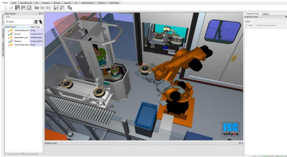
Durch »ISG-virtuos« von ISG entstehen mithilfe von Modulen digitale Zwillinge.
