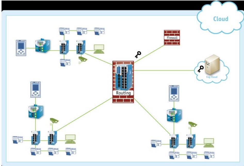
Der Switch »Promesh P20« von Indu-Sol bildet eine zuverlässige Schnittstelle zwischen IT und OT.
