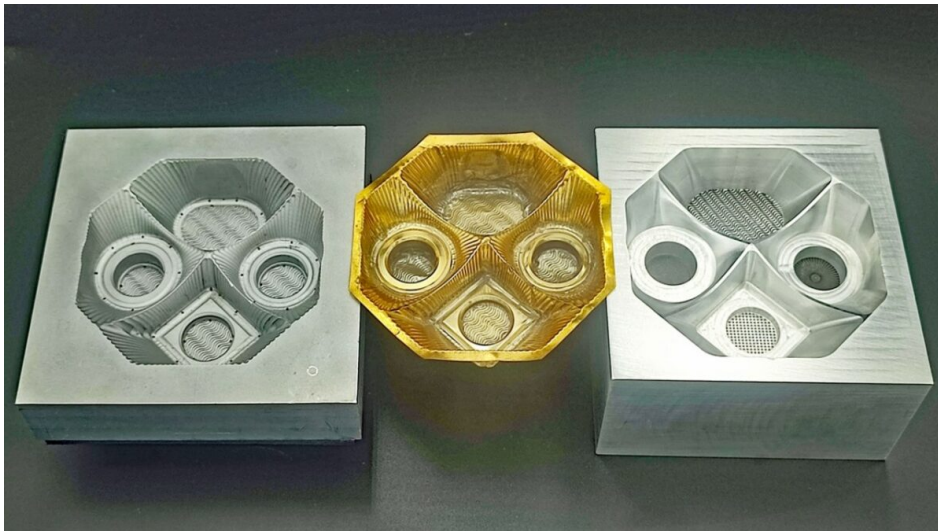
Anwendungsbeispiel Spritzgießformen Pralinen-Inlays (Bild: Lang).
