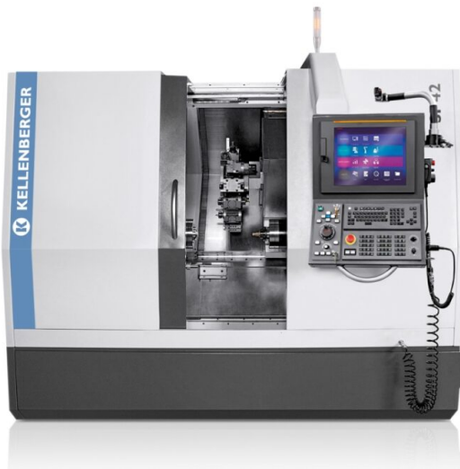
Hochpräzisions-Hartdrehmaschine »SP42« (Bild: Kellenberger).
