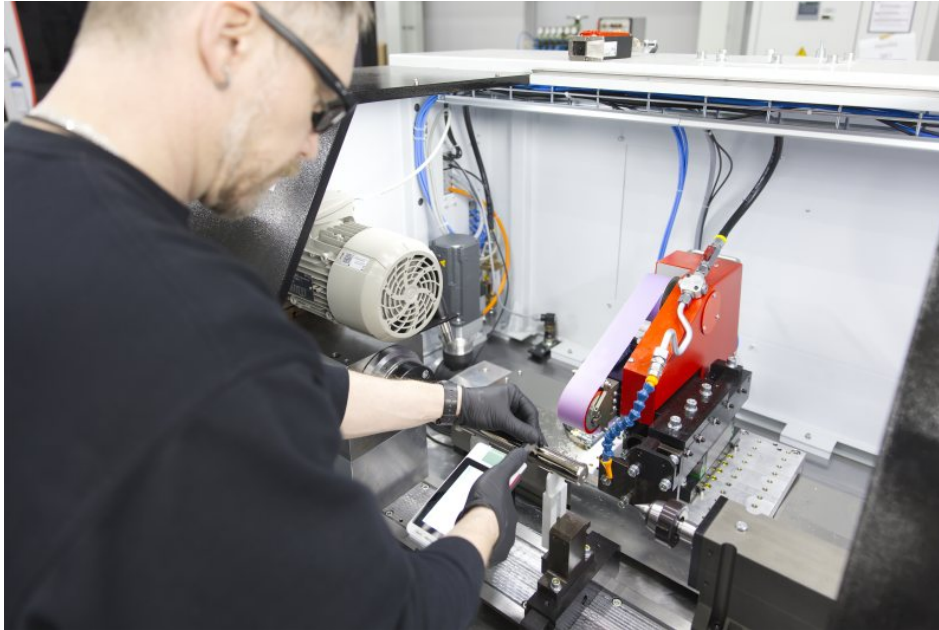
Oberflächenmessung eines Werkstücks nach der Bearbeitung zur Qualitätskontrolle des Superfinish-Prozesses (Bild: Supfina).
