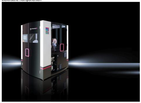
Das neue »Wire Terminal« von Rittal konfektioniert vollautomatisch Drähte.
