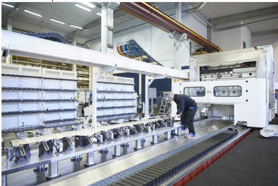
Bis zu 700 Meter Kabel von Lapp stecken in einer Modig-Maschine, der Großteil in Energieketten. Bild: Hannover Messe/Ralf Baumgarten.
